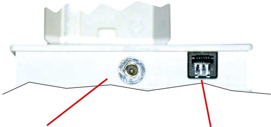
Verbinden Sie diese Buchse mit dem Netzteil.
