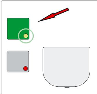
Der ARA befindet sich im betriebsbereiten Ruhezustand - grünes Dauerlicht - **durch drücken der grünen Taste, wird ein ausgelöster Ruf ausgesetzt bzw. abgebrochen.**
