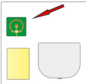
Die Einstellung kann über das Blinken der grünen Leuchte kontrolliert werden, pro 30 Sekunden blinkt die Leuchte einmal, im Sekundentakt, je nach Einstellung also bis zu 9 x - nach einem „Durchlauf“ ca. 2 Sekunden Pause.
