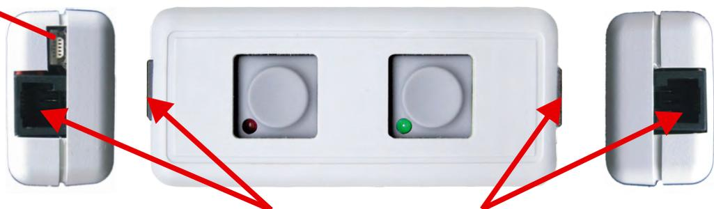
Buchse links oder Buchse rechts, mit der Rufanlage verbinden.
